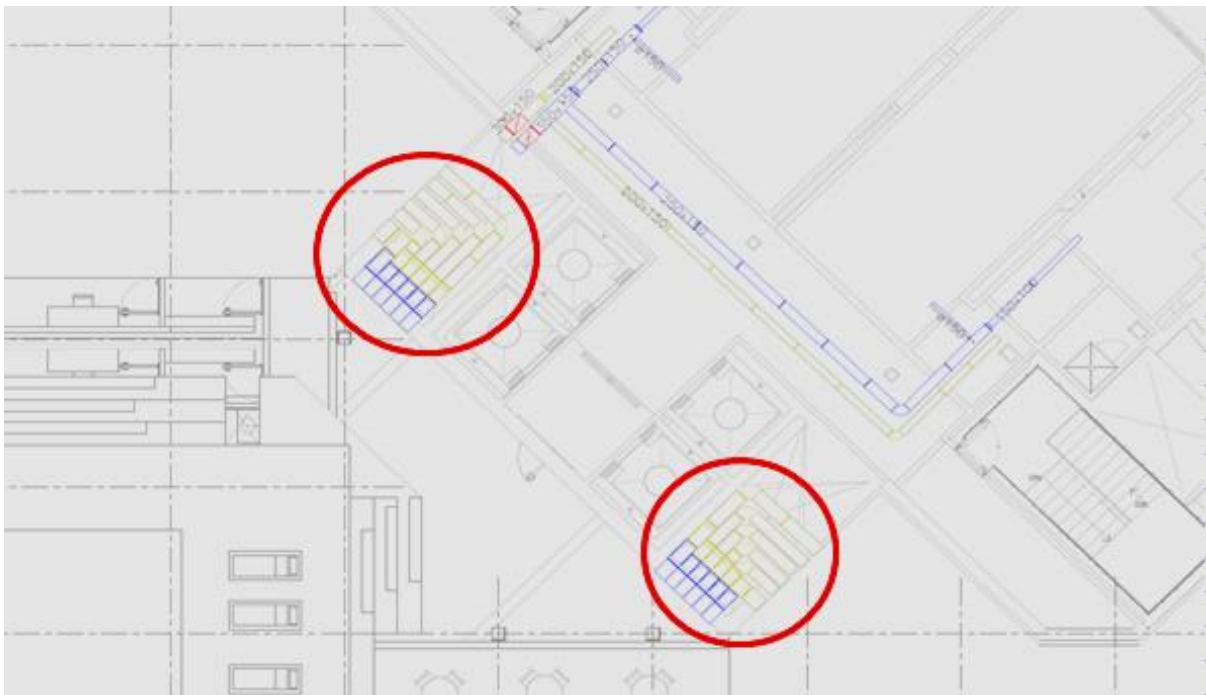
Figura 2 con i cerchi in rosso si individuano le aree di posizionamento delle macchine dell'hotel in copertura
