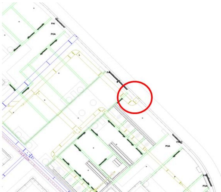
Figura 1 nel cerchio in rosso sono localizzate le bocche di immissione di espulsione dell'area presenti al piano terra
